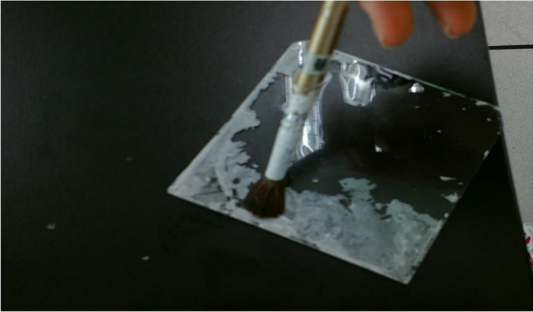
塗上5:1隔熱漆水溶液的玻璃片
